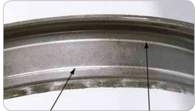
Patrón de desgaste del labio primario
