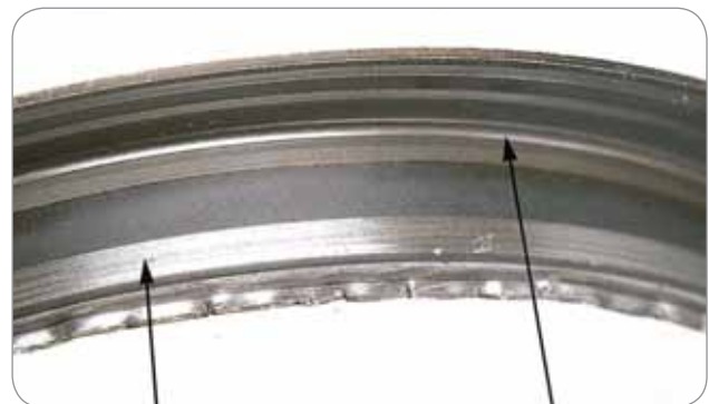
Patrón de desgaste del labio primario
