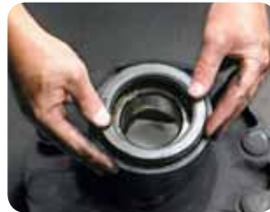
Presione el sello a mano y en forma uniforme insertándolo en el orificio.
